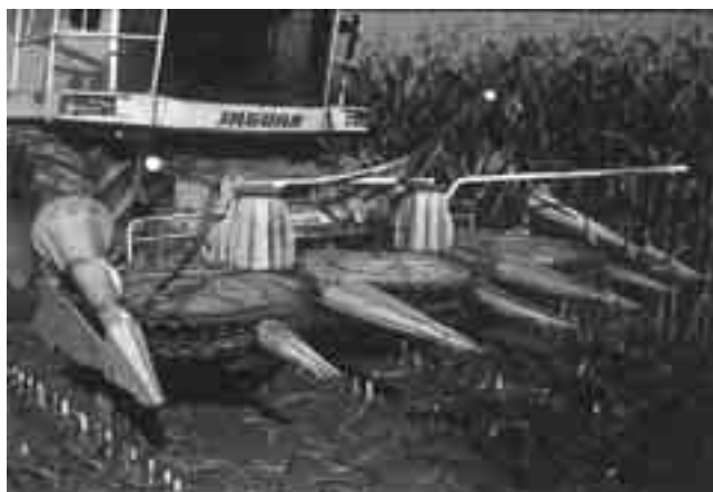
Fig. 12.1 Een zelfrijdende hakselaar met een rijonafhankelijke invoer
