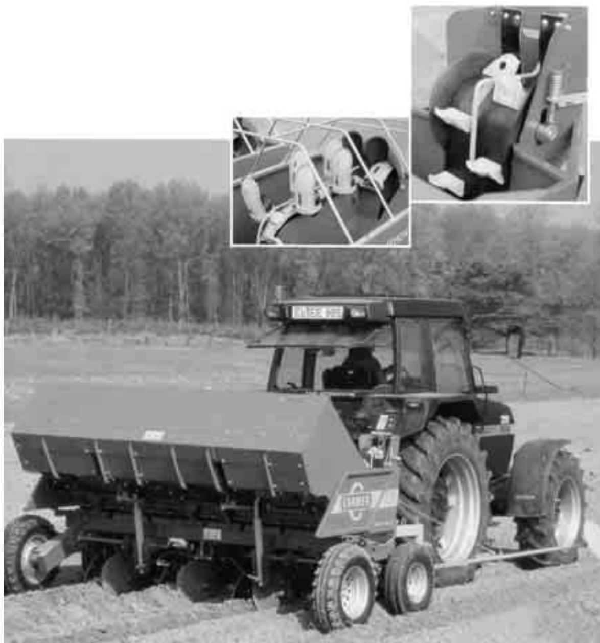
Fig. 2.3 De onderdelen van een aardappelpootmachine; het werktuig rechtsboven heeft bekers en het werktuig middenboven heeft lepels.
