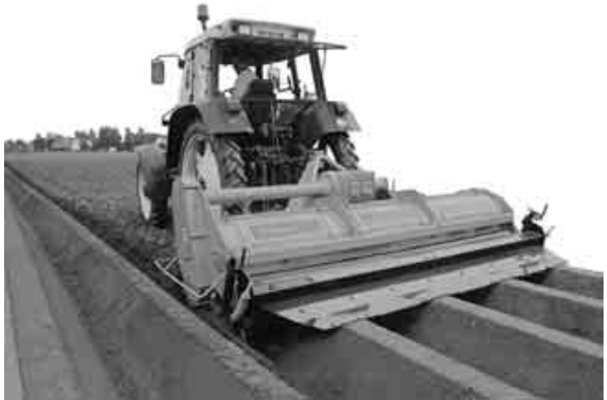
Fig. 4.34 Rijenfrees met kap voorzien van rugvormers
