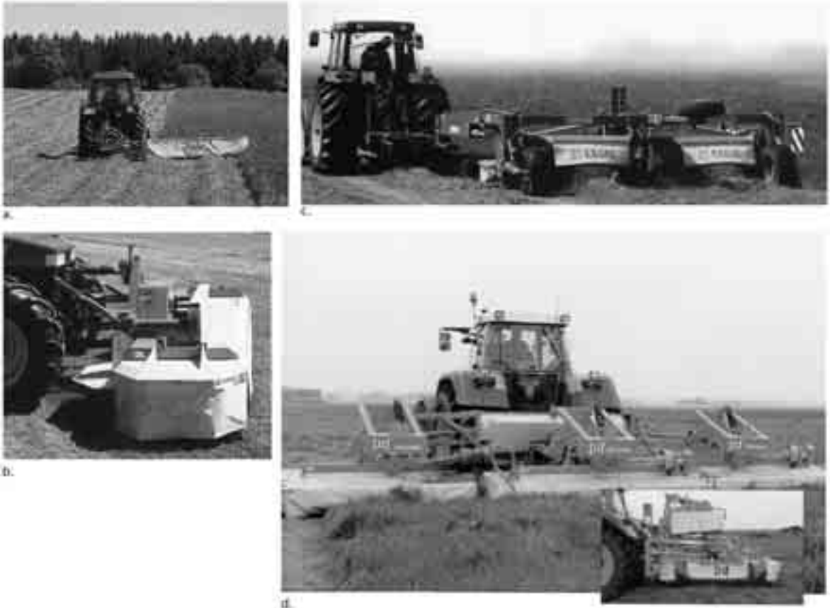
Fig. 7.9 Maaiers kun je op verschillende manieren aan de trekker bevestigen: achter de trekker in de hefinrichting (a), voor de trekker (b), achter de trekker in een onderstel (c) en als maaicombinatie (d).
