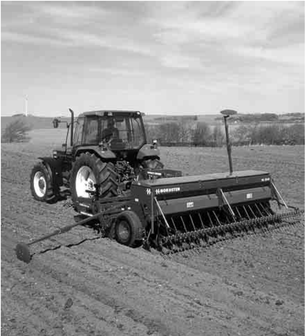
Fig. 1.3 Een pijpenzaaimachine kan ook aan de hefinrichting van de rotorkoepel bevestigd zijn.
