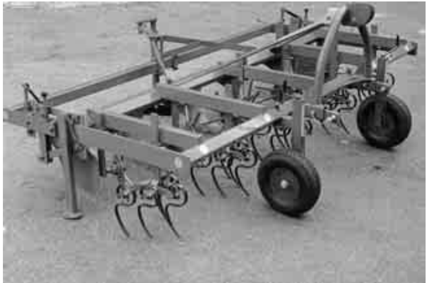
Fig. 4.37 Aanaardgarnituur met triltanden en rugvormers
