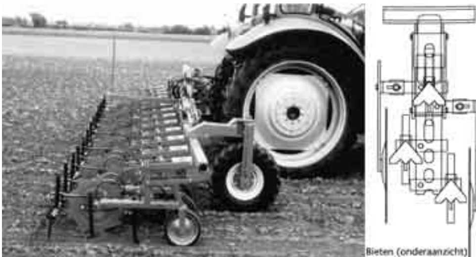
Fig. 4.10 Een schoffelmachine snijdt het onkruid en de opslagplanten af of trekt ze los.
