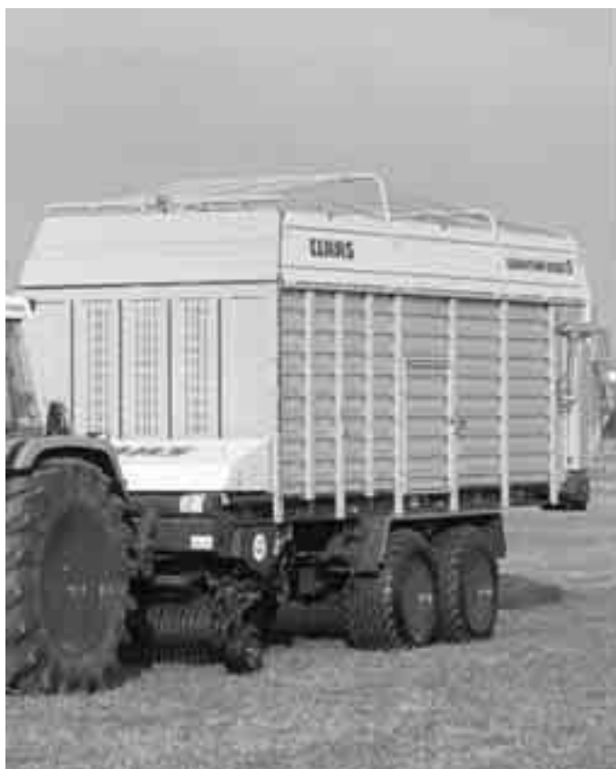
Fig. 10.3 Bij een stekende opraper heb je goed zicht op het werk.
