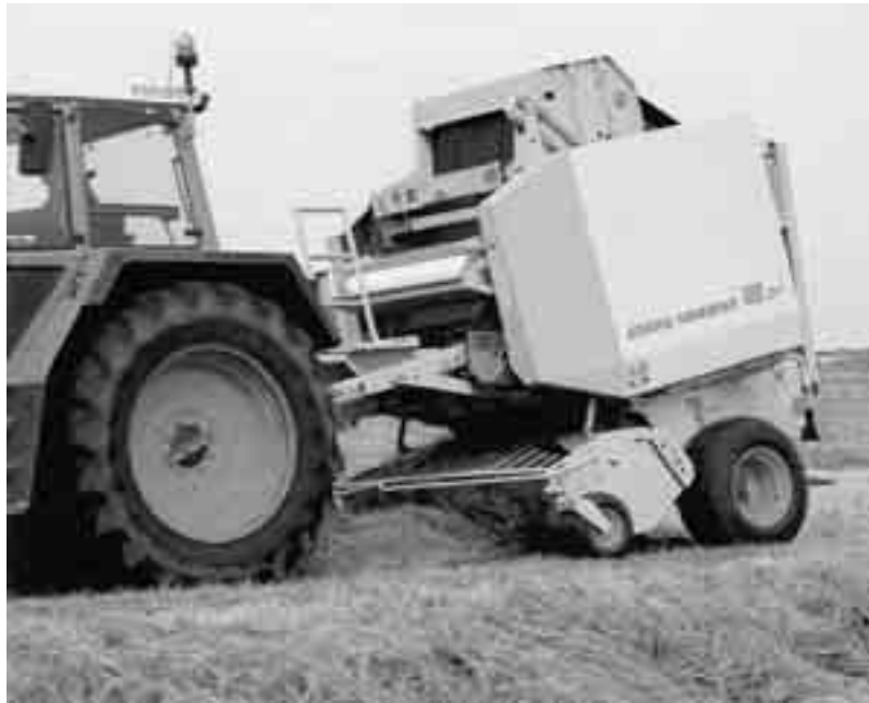
Fig. 11.7 Een oprolpers wordt veel gebruikt voor het inkuilen van gras.
