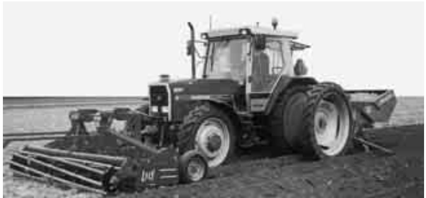
Fig. 2.1 Een aardappelpoot- machine in combinatie met een grondbewerkingswerk- tuig en rugvormers
