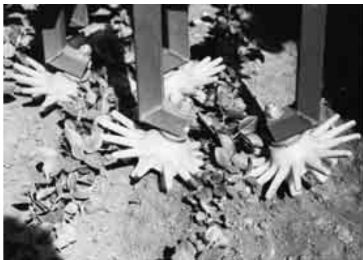
Fig. 4.27 Vingerwieders zijn draaiende schijven met vingers die in de gewasrij lopen en het onkruid los woelen.
