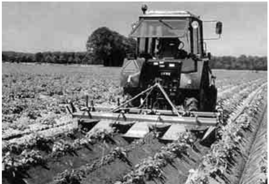
Fig. 4.38 Klepjes in de rugvormkappen dienen om na opkomst van het gewas te kunnen aanaarden.
