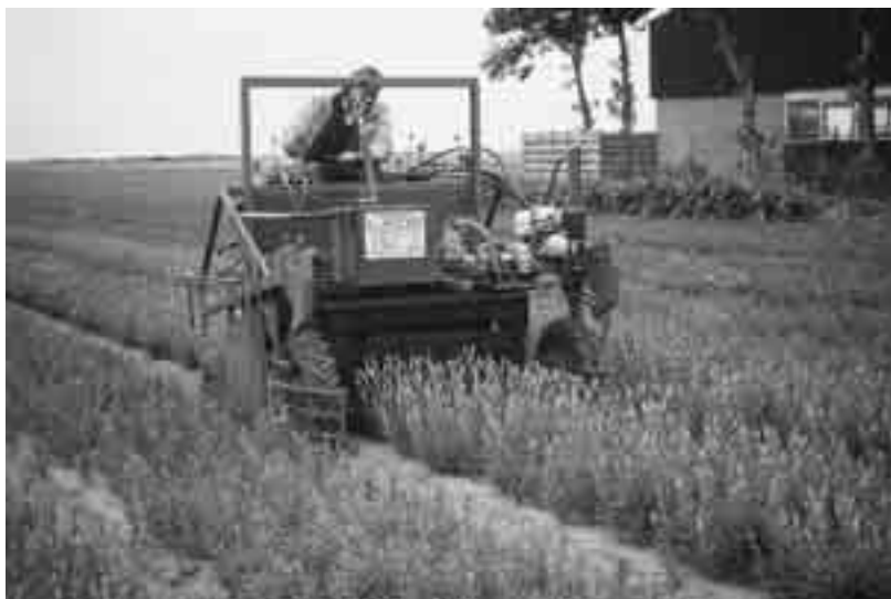
Fig. 4.41 Het machinaal koppen van lelies gebeurt met een maaibord met een messenbalk en daarboven een haspel.
