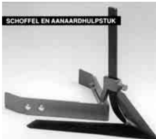
Fig. 4.30 Een aanaardhulpstuk schuift de losgeschoffelde grond opzij.
