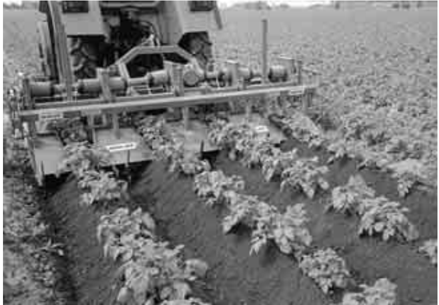
Fig. 4.36 Met een rijenfrees met afzonderlijke elementen kun je in een hoog gewas frezen.
