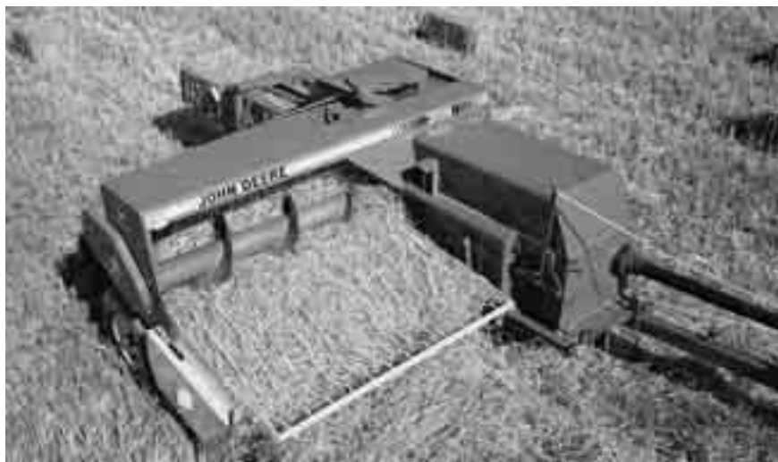
Fig. 11.1 De kleine pakkenpers of opraappers wordt gebruikt voor het persen van hooi en stro.
