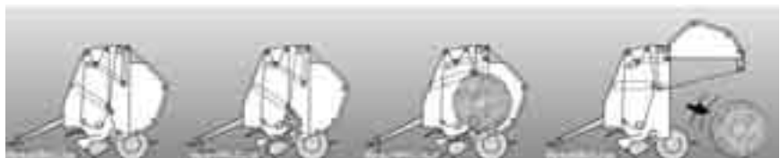
Fig. 11.8 Een oprolpers die rollen maakt met een harde kern
