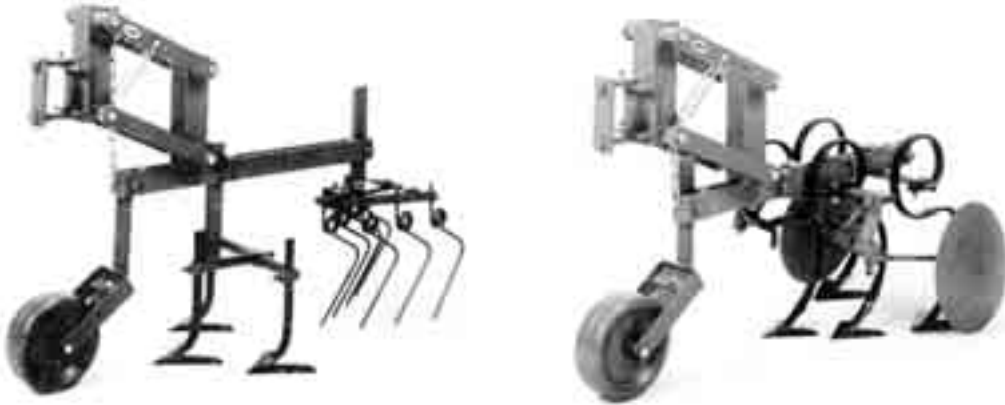
Fig. 4.11 Schoffelelementen: vaste schoffels (links) en triltandschoffels (rechts)
