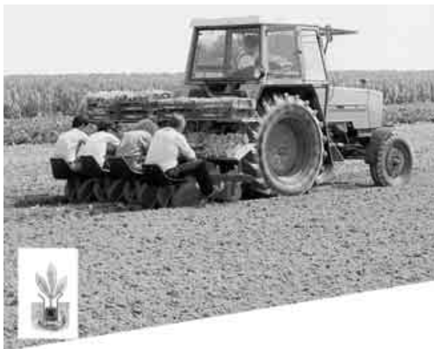
Fig. 3.1 De standaardplant- machine en een plantelement
